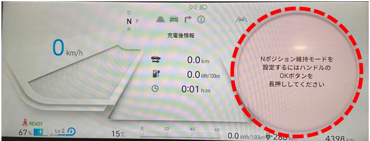
3. その後、またブレーキペダルを踏み、ステアリングホイールの[OK]ボタンを長押ししてください。
